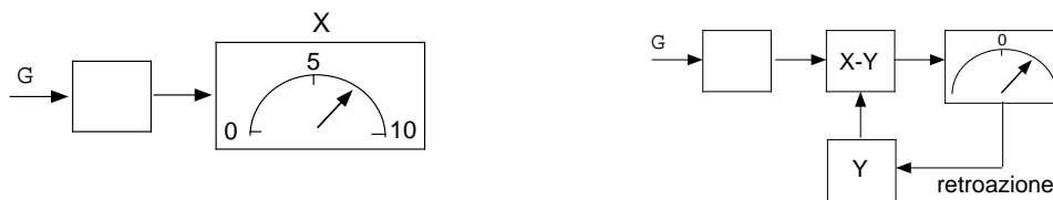
Fig. 3.2 – Confronto schematico tra uno strumento con uscita a deviazione (a sinistra) e uno strumento con uscita a zero (a destra). Nel primo caso la catena di misura è aperta, nel secondo caso è chiusa.
