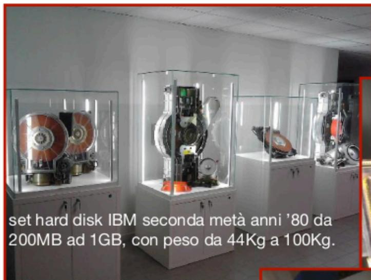
set hard disk IBM seconda metà anni '80 da 200MB ad 1GB, con peso da 44Kg a 100Kg.
