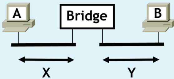
Si consideri la configurazione in figura (i ritardi X e Y non sono in scala), dove il bridge memorizza interamente le trame ricevute da un segmento prima di trasferirle sull'altro segmento. Le stazioni e il bridge adottano il protocollo di accesso CSMA persistent.
