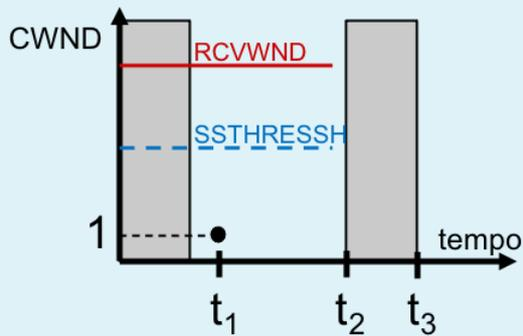
Si consideri lo schema di evoluzione della CWND nel TCP mostrato in figura. L'evoluzione prima del tempo  $t_1$  non ha nessuna influenza, ciò che conta sono il valore delle variabili, che sono:
