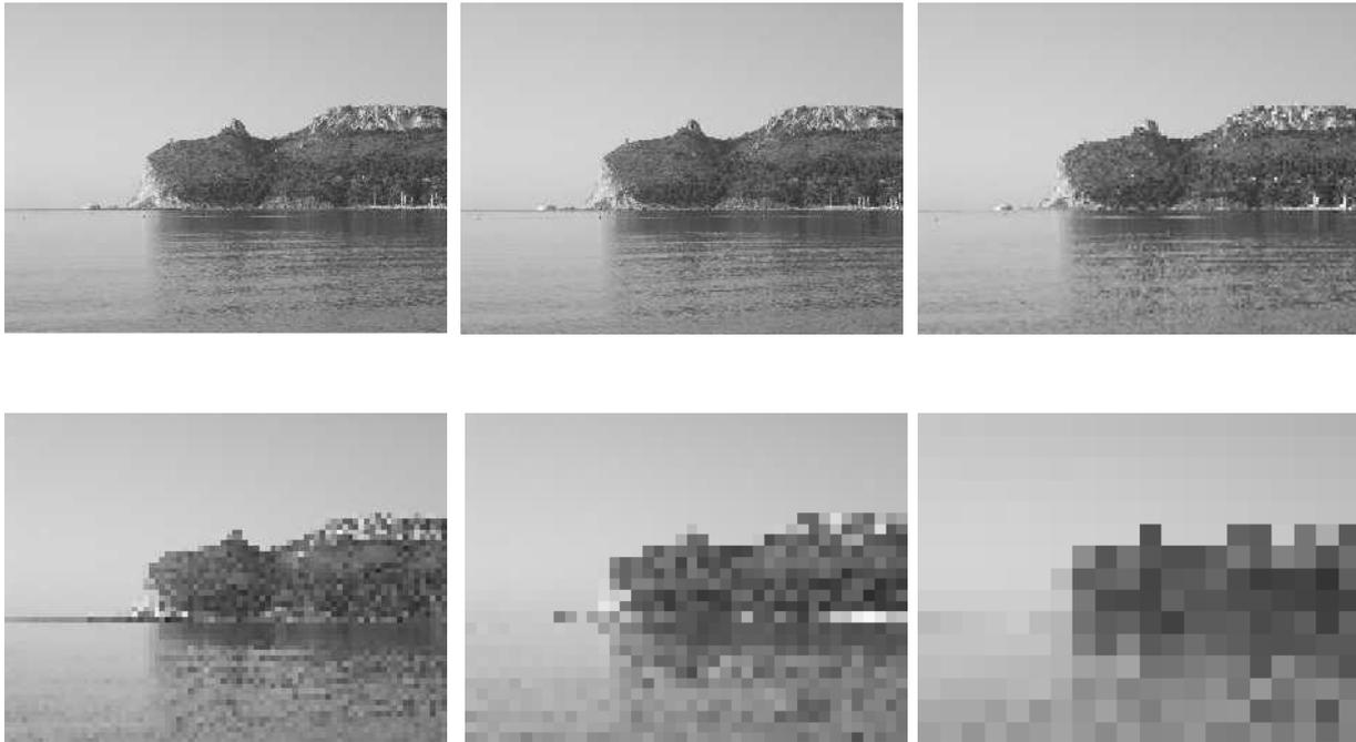
Figura 40: Stessa immagine acquisita con differenti risoluzioni spaziali quanto l'occhio umano non è in grado di distinguere più di un centinaio di differenti livelli di grigio. Otto bit codificano 256 livelli differenti di grigio e quindi sono sufficienti. Se si scende sotto tale soglia, tuttavia, la perdita di qualità diventa via via rilevante e compaiono effetti fastidiosi come i falsi contorni (“posterizzazione”) evidenziati nella Figura 41.
