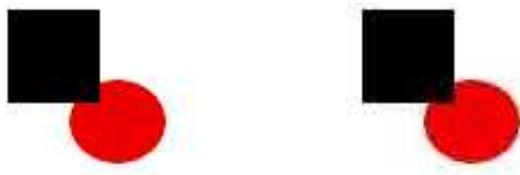
Figura 42: Un disegno a due colori sarà rappresentato ottimamente con un metodo basato su tavolozza di colori come gif (a sinistra), mentre a parità di dimensione del file sarà rappresentato con molti artefatti da metodi che comprimono in frequenza come jpg (a destra).
