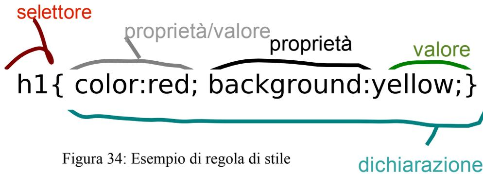
Figura 34: Esempio di regola di stile
