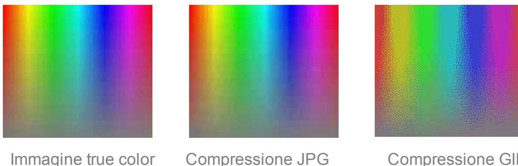
Figura 43: Differenza tra compressione basata su taglio frequenze (jpg) e su palette di colori (gif): quest'ultimo metodo non si adatta ad immagini sfumate.
