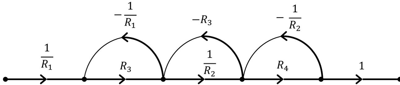
$$T = \frac{R_3 R_4}{R_1 R_2 + R_1 R_3 + R_1 R_4 + R_2 R_3 + R_3 R_4}$$
