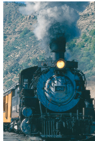
Figura 22.1 Questa locomotiva a vapore sta viaggiando fra Durango e Silverton in Colorado. Produce energia bruciando legna o carbone. L'energia prodotta trasforma l'acqua in vapore, che muove la locomotiva. (Questa locomotiva deve rifornirsi di acqua da serbatoi situati lungo la strada ferrata per riempire il fumaio.) Le moderne locomotive usano il gasolio come combustibile al posto della legna e del carbone. Sia le antiche che le moderne locomotive sono macchine termiche, che estraggono energia dalla combustione di un carburante e ne convertono una parte in energia meccanica.
