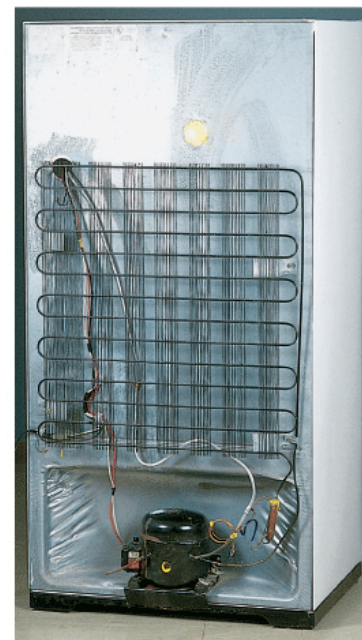
Figura 22.6 La serpentina sul retro del frigorifero trasferisce energia sotto forma di calore all'aria. Considerando che energia entra nel sistema come lavoro, tale quantità di energia deve essere maggiore della quantità di energia prelevata dagli oggetti contenuti nel frigorifero.
