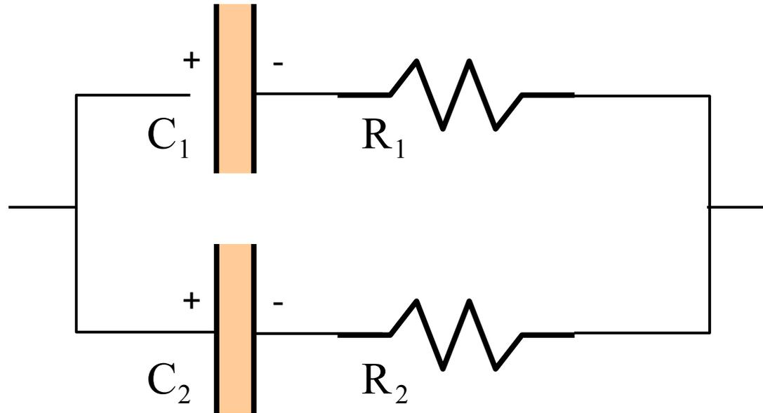
$C_1$  e  $C_2$  non danno luogo a tipi di comportamento in diretta opposizione. Semplicemente, si appoggiano allo stesso flusso di cariche  $i$  e ne ripartono la corrente in  $i_2$  e  $i - i_2$
